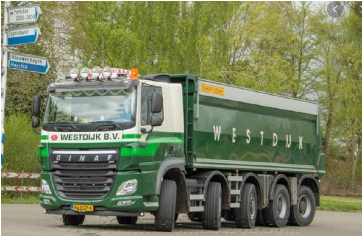
Figuur 4. Voor het transporteren van het asfalt zijn 8x4 en 8x10 vrachtwagens gebruikt door verschillende transporteurs. Hierboven staat een voorbeeld van het type vrachtwagen 10x4. 10x4 staat voor het aantal assen.
