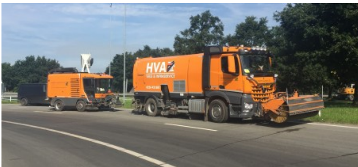
Figuur 11. Veegzuigwagen van HVA Veeg & Infraservice (ingebruikt door Boskalis). De veegzuigauto is ingezet voor het reinigen van het asfalt.
