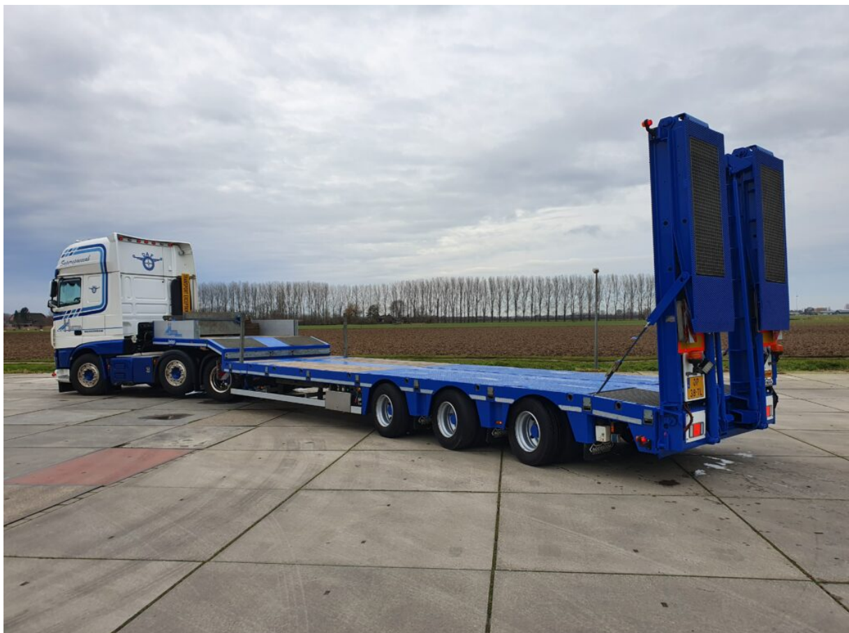
Figuur 5. Voor het transporteren van het grote materieel zoals de asfaltzet en de freesmachines is een vrachtwagen met dieplader ingezet door verschillende transporteurs.
