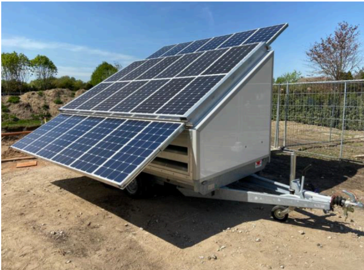
Figuur 14. Volta Energy zon-aggregaat, ingezet voor de energievoorziening op locatie.
