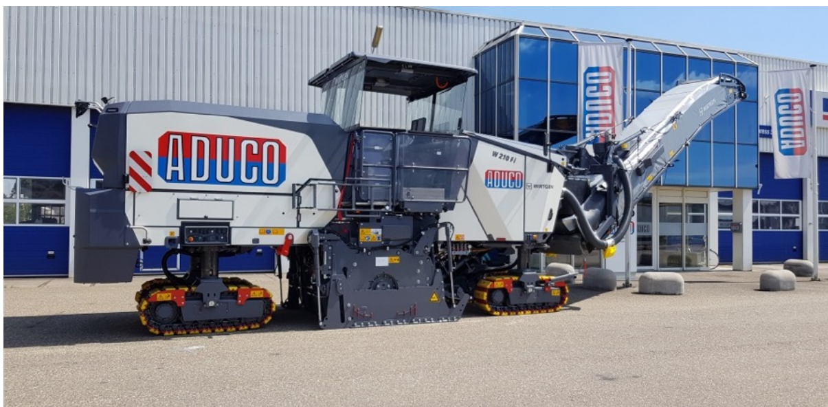
Figuur 12. Freesmachine 210 Fi van ADUCO (ingebruikt door Boskalis), ingezet voor het grote freeswerk.
