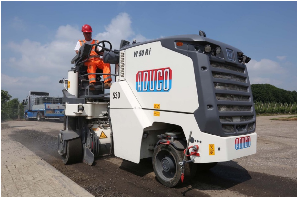
Figuur 8. Freesmachines van 0,5 meter van het bedrijf ADUCO (ingehuurd door Boskalis) om de kantjes goed af te werken.
