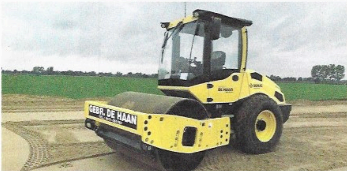
Figuur 6. Hierboven is een wals te zien van de Haan. Met een wals heeft De Haan grond platgewaist om een egaal oppervlak te krijgen zodat de ondergrond goed aan bereid is op het aanleggen van de weg.
