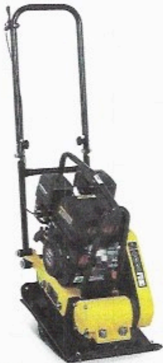
Figuur 9. Hierboven is een voorbeeld weergegeven van een trilplaat. NTP heeft op de projectlocatie een trilplaat ingezet voor het egaal maken van kleine stukken zand. De trilplaat heeft dezelfde functie als een wals, maar is met de hand te besturen en kan zo preciezer kleine stukken egaliseren.
