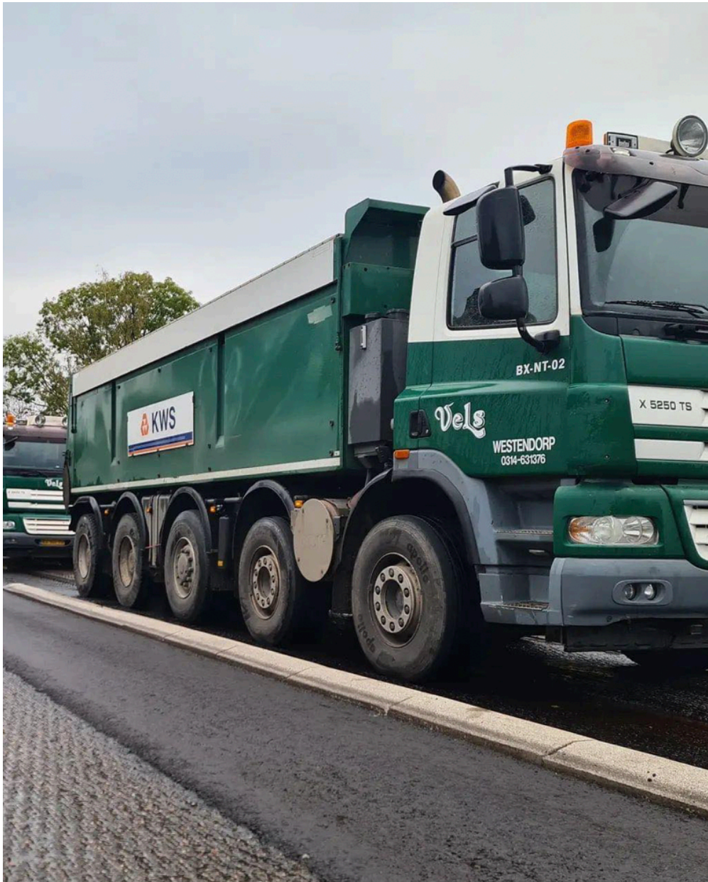
Figuur 4. Voor het transporteren van het puin zijn 10x4 en 8x4 vrachtwagens gebruikt door KWS. Het transport is uitgevoerd door Vels Transport B.V. (onderaannemer). Hierboven is een voorbeeld van het type vrachtwagen 10x4 te zien. 10x4 staat voor het aantal assen.
