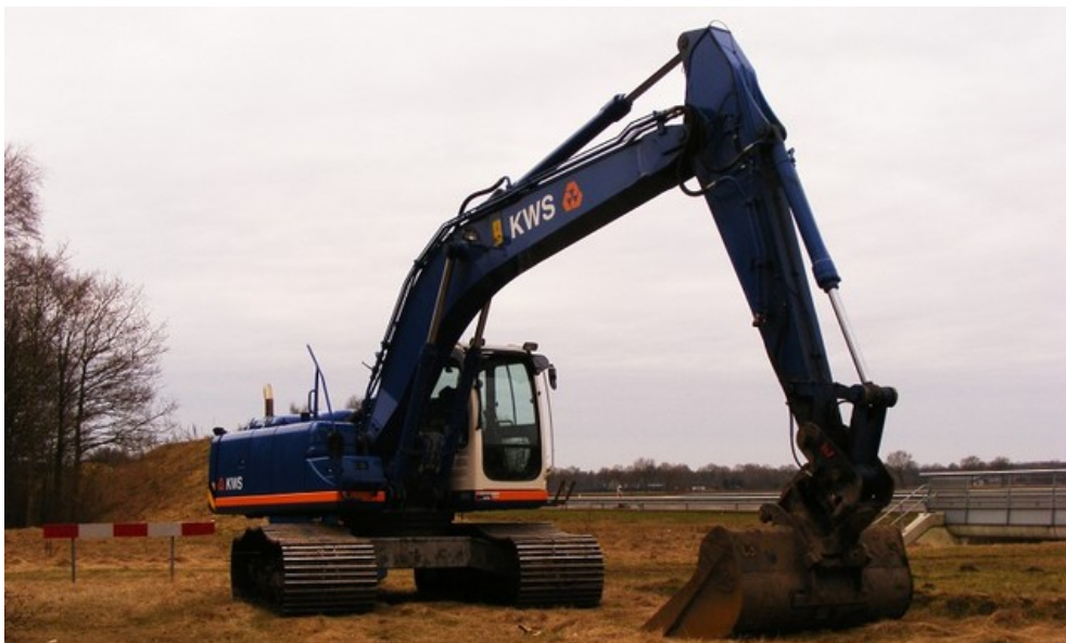
Figuur 6. Hierboven is een voorbeeld van het type kraan te zien dat is ingezet voor dit project gebruikt door KWS. Deze kraan heeft de oude fundering eruit gesloopt en in de vrachtwagens getild. Ook heeft deze kraan het betonpuingranulaat aangebracht op de weg om de fundering te vormen.
