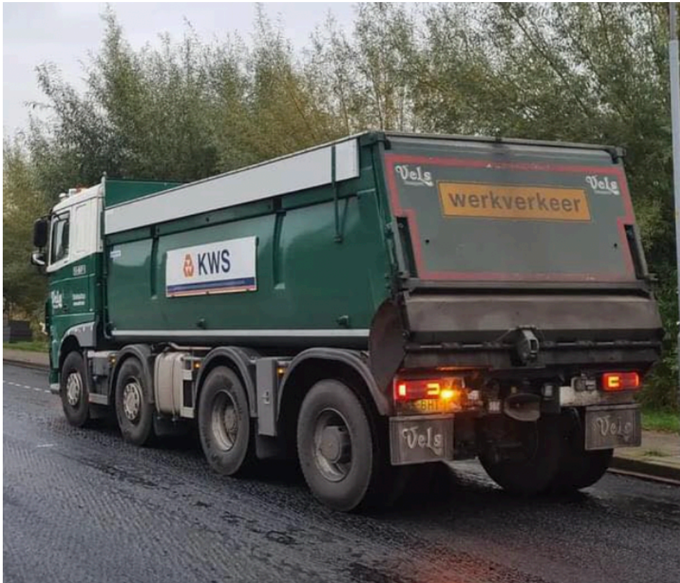
Figuur 5. Hierboven is een voorbeeld van het type vrachtwagen 8x4 te zien gebruikt door de onderaannemer Vels Transport B.V.. 8x4 staat voor het aantal assen.
