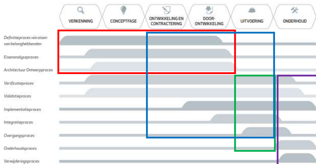
Figuur 3: projectfasering volgens Leidraad Systems Engineering ( www.leidraadse.nl )
