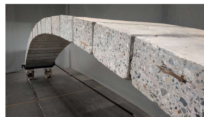
Figuur 10: Gerecycled beton voor voetgangersbrug
