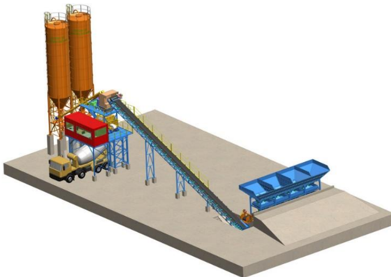
Figuur 3: Principe van de lay-out van een betoncentrale ( https://grabcad.com/library/concrete-batching-plant-3 )
