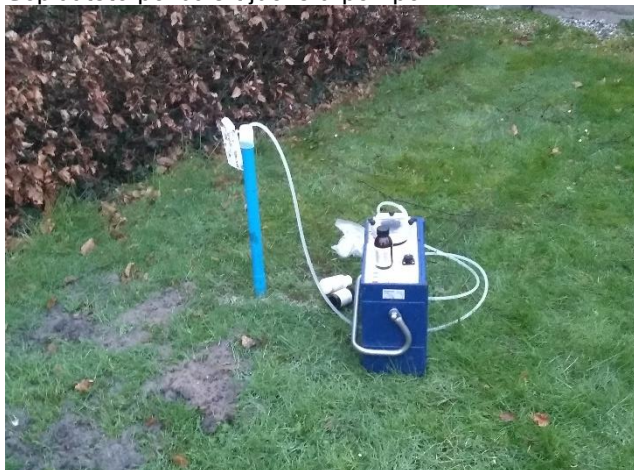
Geplaatste peilbuis tijdens afpompen
